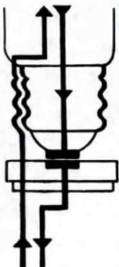
Оба электрических провода, войдя в патрон, расходятся в разные стороны.
